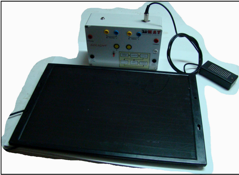
Le SOLIGHT-SECURITY avec son panneau solaire et son éclairage à Leds blanche
